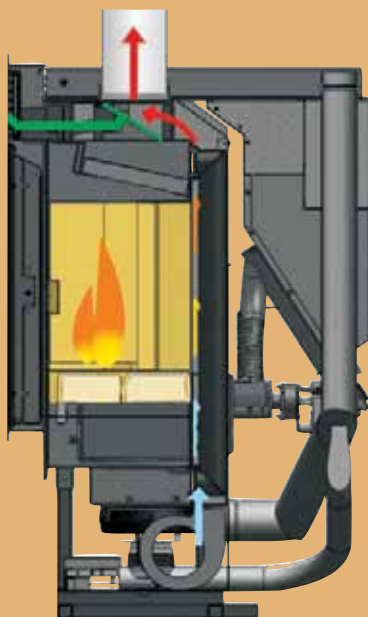
Teplý vzduch vháněný do rozvodů
